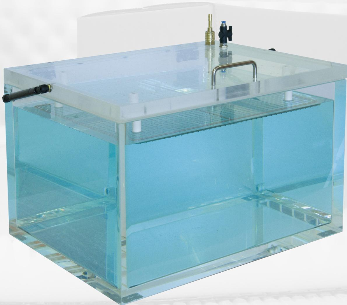
Zum Testen von nahezu allen Verpackungen unter Vakuum wird der Verpackungstester, der mit einer digitalen Druckanzeige und automatischer Entlüftung entwickelt wurde, eingesetzt. Die heutigen Qualitätsstandards in der Verpackungsindustrie erfordern genau diese stichprobenartige Untersuchung. Das äußerst benutzerfreundlich zu bedienende Gerät ist ideal für Laboreinsätze, da die
