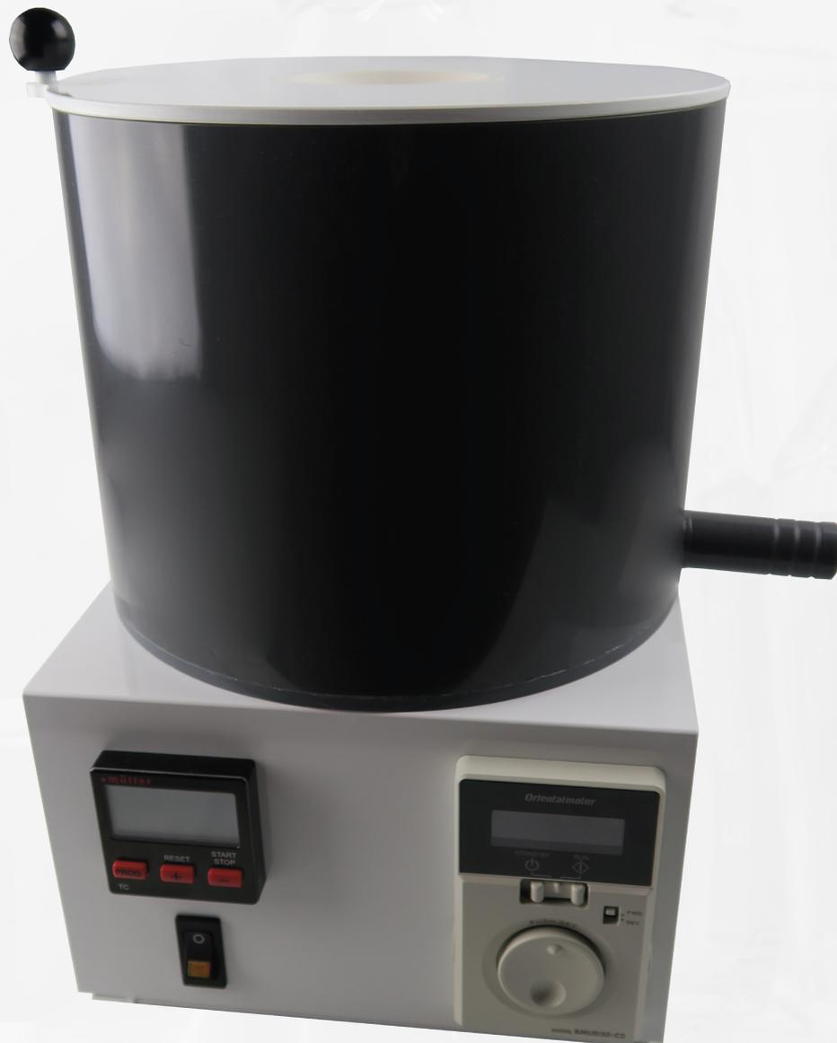
Die Aerne Analytic Saftzentrifuge wird in der Lebensmittelindustrie zur Bestimmung des Fruchtfleischanteils in Säften verwendet. Speziell für Lebensmittelhersteller ist die Saftzentrifuge ein notwendiges Instrument
