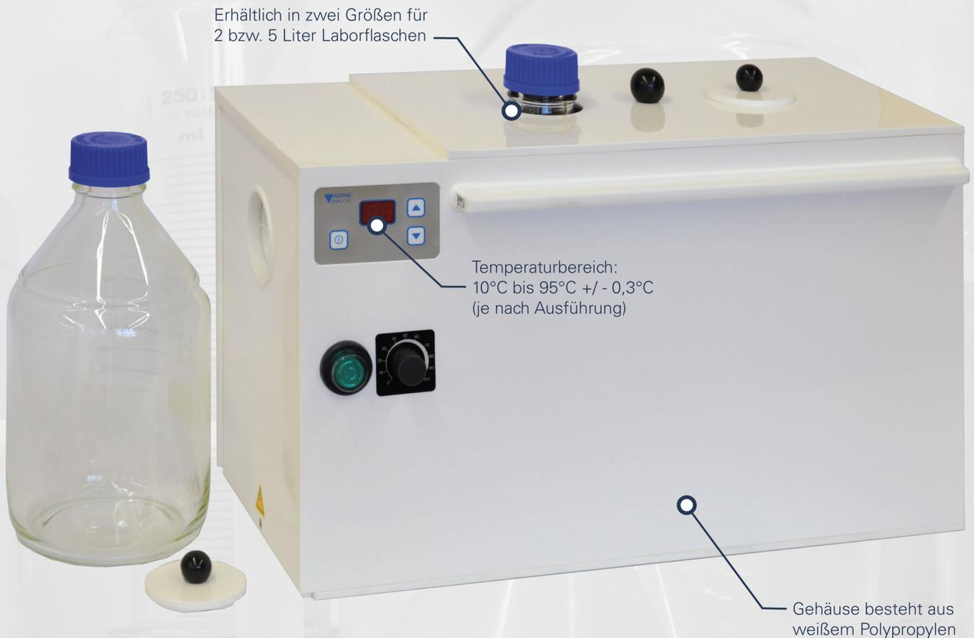
Das Aerne Analytic Magnetührwasserbad wird hauptsächlich zum Kochen und Auflösen von Nährböden in der Mikrobiologie verwendet. Ausgerüstet ist das Gerät mit zwei Magnetührstellen, die gemeinsam stufenlos regelbar sind. Der Auflagendeckel ist für zwei Flaschen mit ISO-Gewinde mit je zwei bzw. fünf Liter Laborflaschen, je nach Gerätetyp, vorgesehen. Bedient wird das Wasserbad
