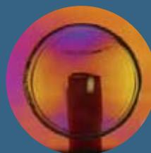
Eindeutige Verifizierung und Bewertung eines Ausschuss-glasses unter Verwendung des Spannungsprüfers.
